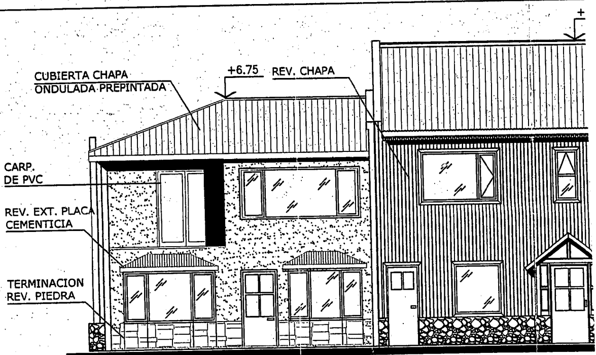
VISTA SOBRE CALLE MIRADORES DE Esc.: 1:100
